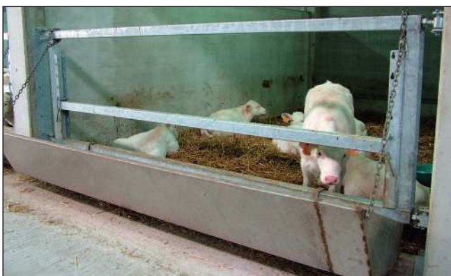
opendraaibaar voederhek met regelbare buis en trog cornadis ouvrant avec tube réglable et auge
