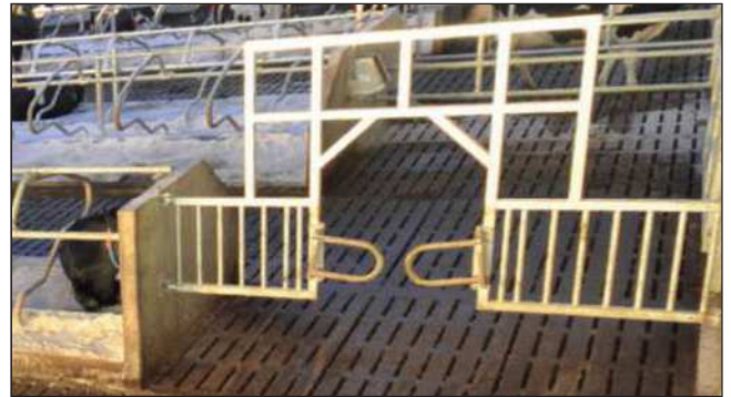
verplaatsbare afscheidingspoorten eenvoudig te verplaatsen naargelang de grootte van de verschillende koppels séparations couloir facile à déplacer, montage sur logettes ou cornadis
